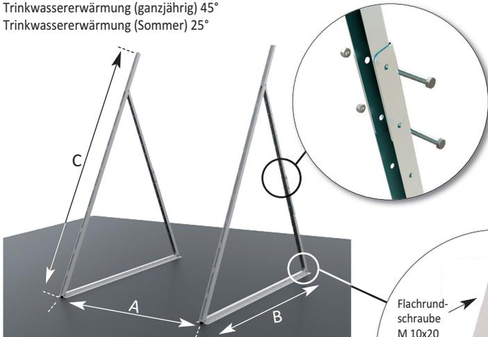
Teleskop-U-Profile zur Einstellung der Kollektorneigung. Zur Sicherung werden zwei Edelstahlschrauben (M8x50) und selbstsichernde Muttern verwendet.
