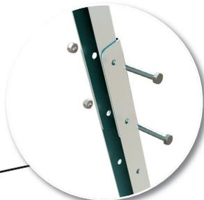
Teleskop-U-Profile zur Einstellung der Kollektorneigung. Soll der Kollektor schwächer geneigt werden, können die U-Profile ineinander geschoben werden. Zur Sicherung werden zwei Edelstahlschrauben (M8x50) und selbstsichernde Muttern verwendet.
