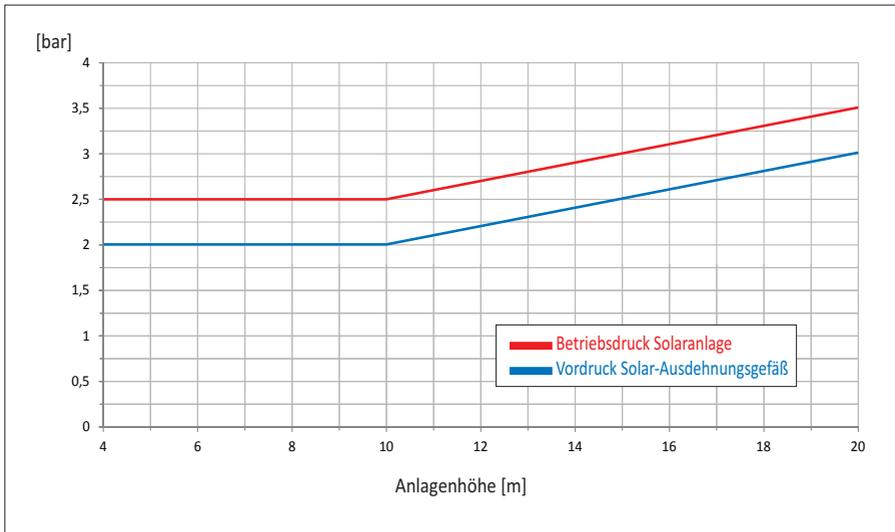
\* Anlagenhöhe ist die gemessene Höhe vom Manometer der Pumpenstation bis zur höchsten Stelle im Kollektorfeld
