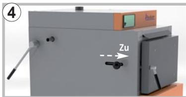
4 Kesseltüre schließen und den Anheizklappenhebel herausziehen, der Abgaskanal ist somit geschlossen (Stellung „Zu“).
