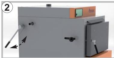
**2** Reinigungshebel einige Male betätigen, die Wärmetauscher werden hiermit gereinigt. Stellung (wie im Bild ersichtlich) ist die reguläre Stellung für den Heizbetrieb
