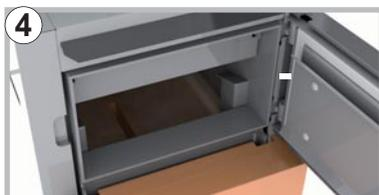
**4** Obere Fülltüre öffnen. Brennerdüse mit Reinigungswerkzeug freimachen. Papier und Anmachholz (Holzspießel) auf die Brennerdüse legen und mit Kohleanzünder oder Espitwürfel anzünden.
