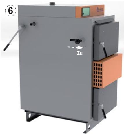
6 Wenn die Flamme hörbar brennt (leicht faucht, lodert), auch die untere Kesseltüre schließen und den Anheizklappenhebel herausziehen, der Abgaskanal ist somit geschlossen (Stellung „Zu“).
