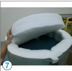
Deckelisolierung einlegen (Position der beiden Stützen beachten)
